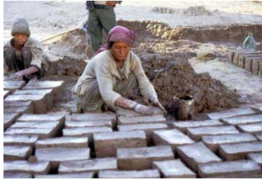
شكل (٢-٢٣٥) صب الطوب اللبن - الهند
