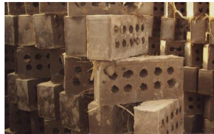
شكل (٢-٢٤٥) طريقة رص وحدات الطوب المفرغة - وحدات الطوب يتم تجفيفها في الشمس وتغطيتها بالقش- مصر
