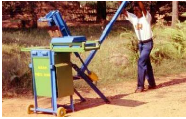
شكل ( ٢٥٠-٢ ) ماكينة حديثة لكبس الطوب يدوي
