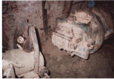
شكل (٢٤٠-٢) الفتحة التي يتم بثق الوحدات منها بها فتحات لتفريغ الوحدات
