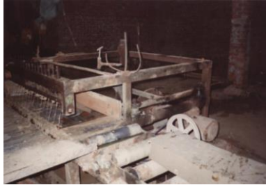
شكل (٢٤١-٢) قضيب من الطفلة يتم وضعة على لوح التقطيع بالسلك - مصر
