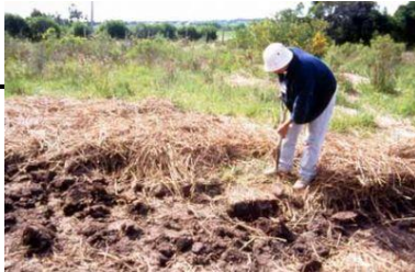
شكل (١-١٠٨) صناعة الطوب من الطبقة العليا للأرض
