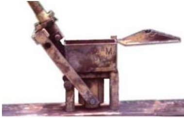
شكل ( ٢٤٩-٢ ) ماكينة بدائية لكبس الطوب يدوي
