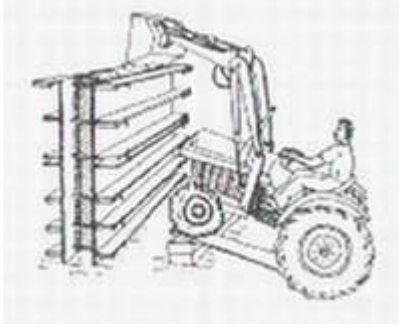
شكل (٣-٥٧٤) اسكتش خطوات العمل الحائط كوحدة للبناء
