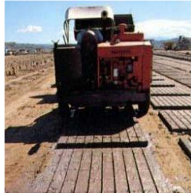
شكل (٢-٢٣٧) صناعة الطوب الولايات المتحدة الأمريكية باستخدام الميكنة
