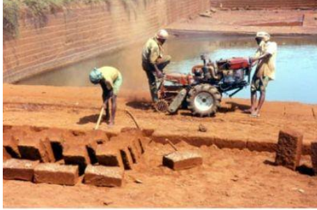
شكل (٢-٢١٨) الهند - استخدام ماكينة في التقطيع
