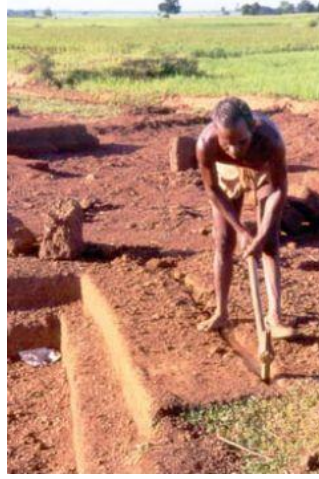
شكل (٢-٢١٧) تسوية الطوب يدوياً - الهند
