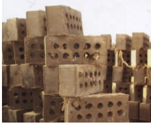
شكل (١-١١٤) صناعة الطوب بعد البثق يتم تجفيفه في الشمس- مصر
