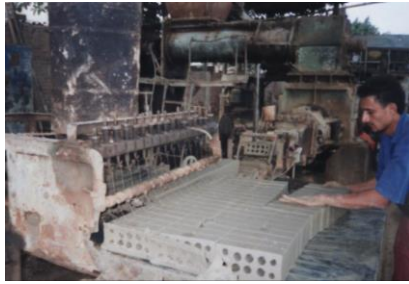
شكل (٢-٢٤٢) (١) قضيب من الطفلة يتم معالجته وتهذيبه - (٢) قضيب من الطفلة يتم وضعه على آلة التقطيع بالسلك
