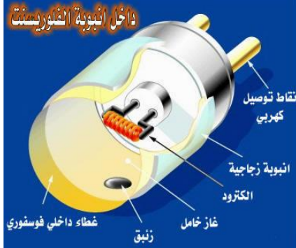
شكل المكونات الداخلية لمصباح الفلورسنت المصدر: http://www.arab-eng.org
